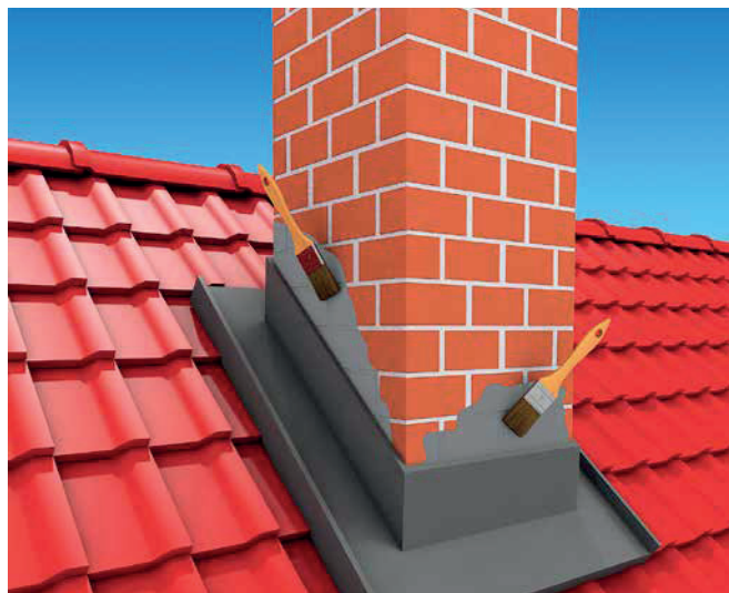
2 Uszczelnienie połączeń z kominami
